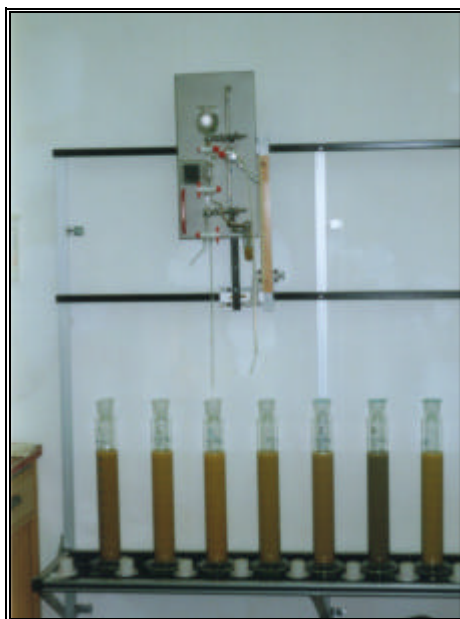
Abb. 8: Versuchsanordnung der KÖHN-Pipettierung.
